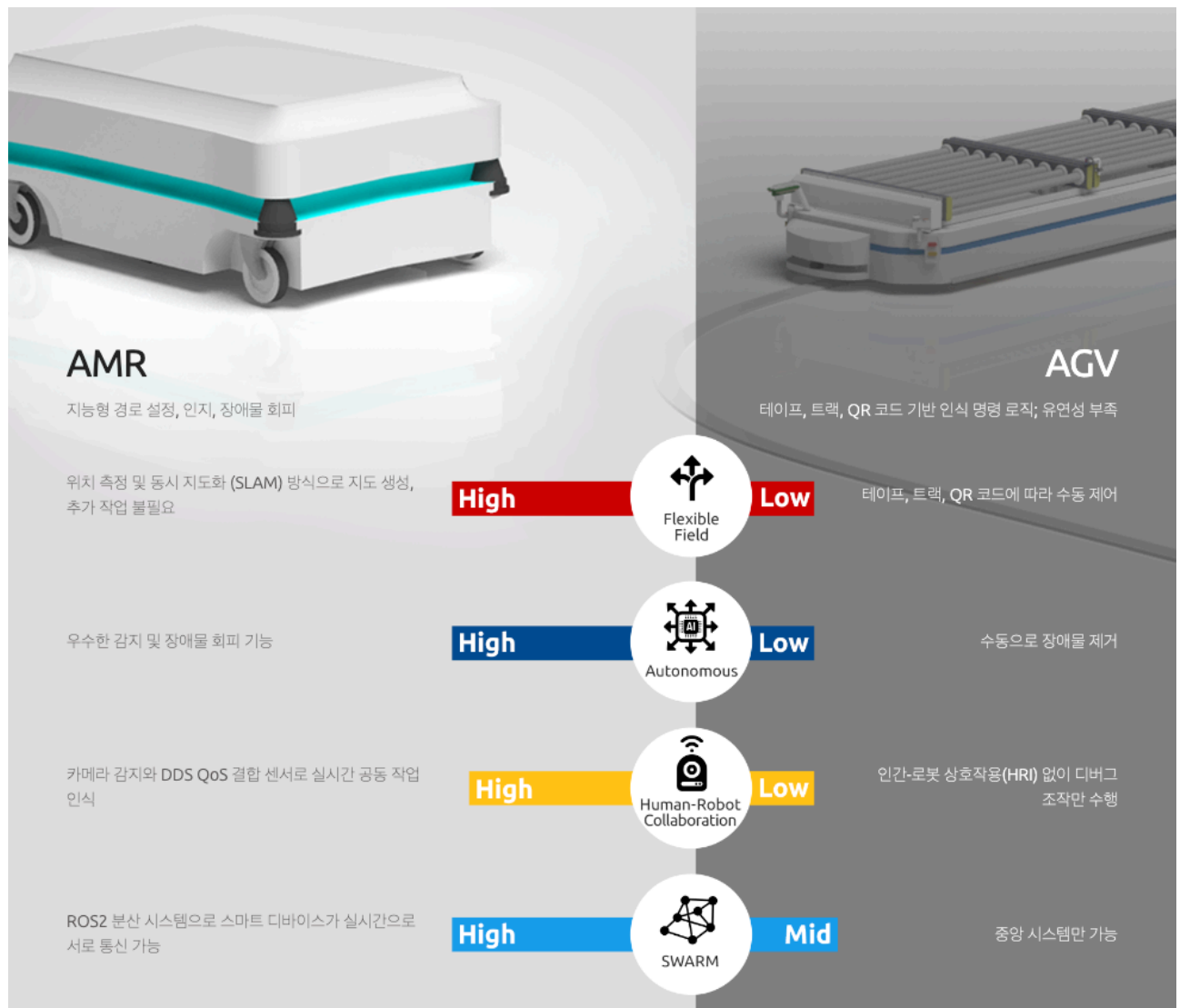
[그림 1. AMR 과 AGV 의 차이. 출처 : ADLINK Technology, Inc.]
